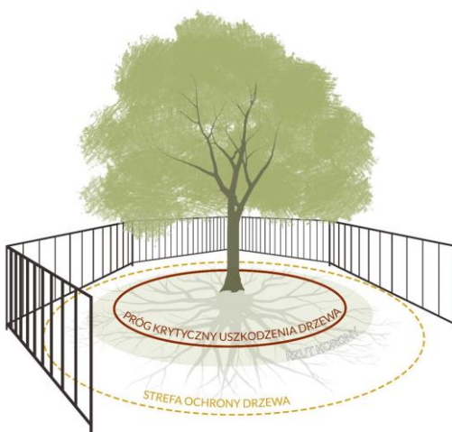
Rysunek 4 Strefa ochrony drzewa (SOD)
